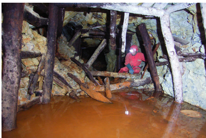
Boisage peu rassurant, eau minéralisée, mine de barytine (Lozère)
